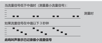
此时,将存储流量信号校准值。您可断开 DP1000 油泵的电源,或者继续运行 DP1000 油泵。
