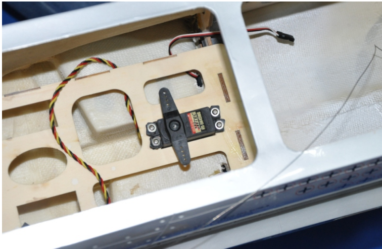
Install Rudder servo.
